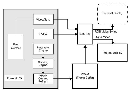
Figure 11-3 Weitek Power 9100 Block Diagram
